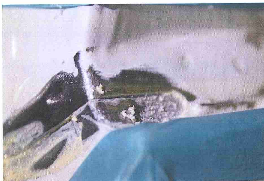
Фото 14. Перемещения кузовных элементов относительно друг друга в правом верхнем углу проема задней двери багажного отсека не выявлено.
