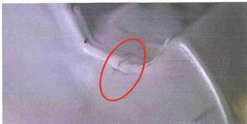
Фото 9. Трещина на поверхности лакокрасочного покрытия в правом верхнем углу проема задней двери багажного отсека. Вид после демонтажа молдинга.
