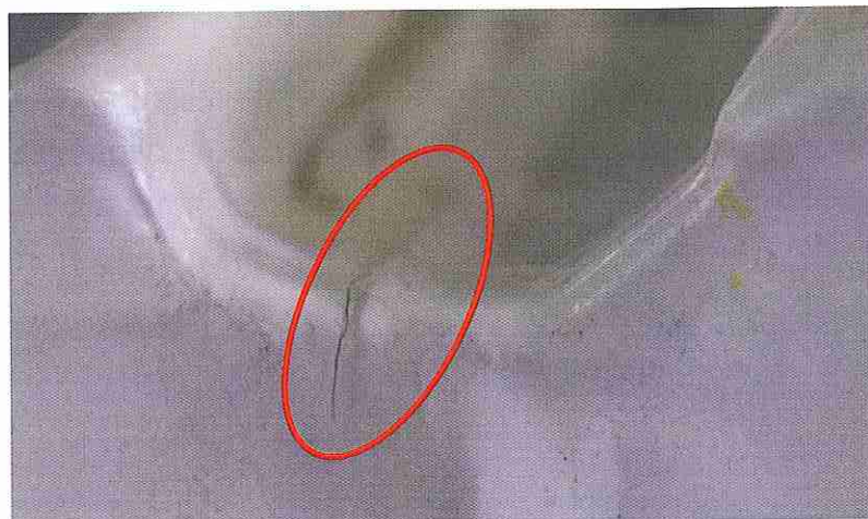
Фото 8. Трещина на поверхности лакокрасочного покрытия в левом верхнем углу проема задней двери багажного отсека. Вид после демонтажа молдинга.
