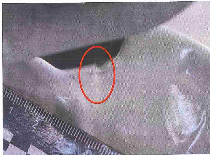
Фото 7. Трещина на поверхности лакокрасочного покрытия в правом верхнем углу проема задней двери багажного отсека.
